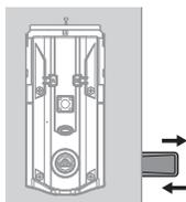
Le loquet se rétracte et s'étend pour déterminer l'orientation de la porte.
