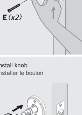
If the knob base will not sit flush on the door, use a flathead screwdriver to remove the alignment guide. Si la base du bouton ne repose pas à fleur de la porte, utilisez un tournevis à tête plate pour retirer le guide d'alignement.
