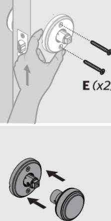
If the knob base will not sit flush on the door, use a flathead screwdriver to remove the alignment guide. Si la base du bouton ne repose pas à fleur de la porte, utilisez un tournevis à tête plate pour retirer le guide d'alignement.
