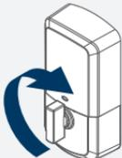
Retirer le couvercle intérieur de l'assemblage intérieur.
